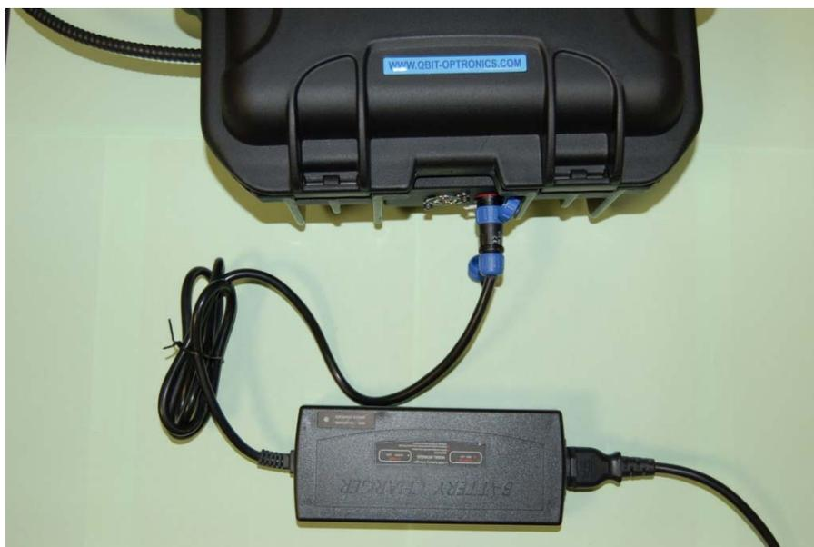
Figura V.1. Collegamento a rete elettrica.
