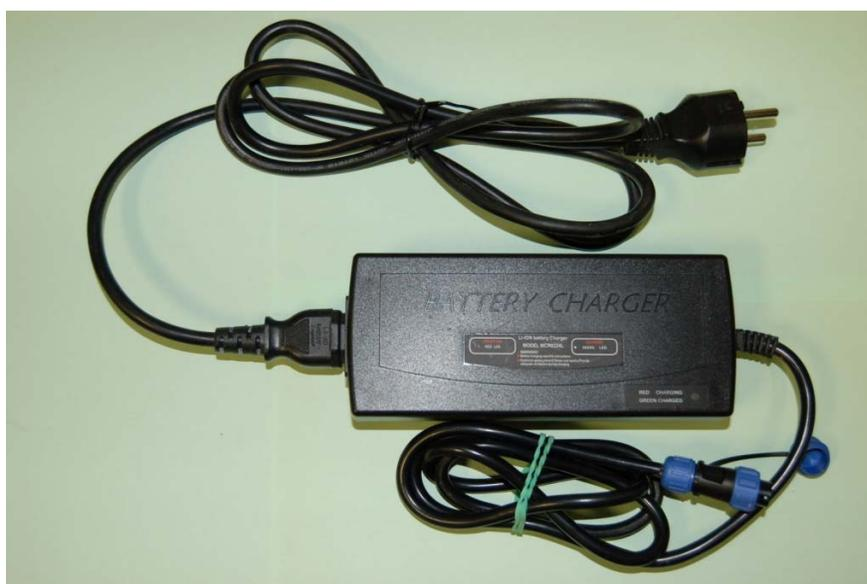
Figura III.4. Alimentatore/caricabatteria.
