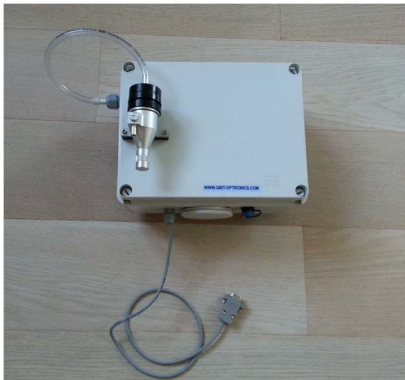
Figura III.1. Aspetto esterno. La figura mostra una unità in configurazione standard con il filtro ciclone e il cavo di interfaccia RS232.
