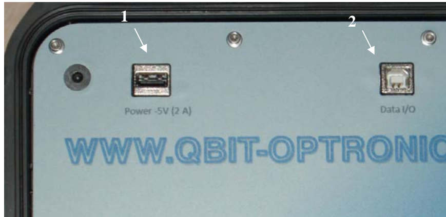
Figura III.2 Dettaglio Prese USB: Pannello principale. Sono visibili: 1) presa USB-A [Power 5V-2A] e 2) presa USB-B [dati]
