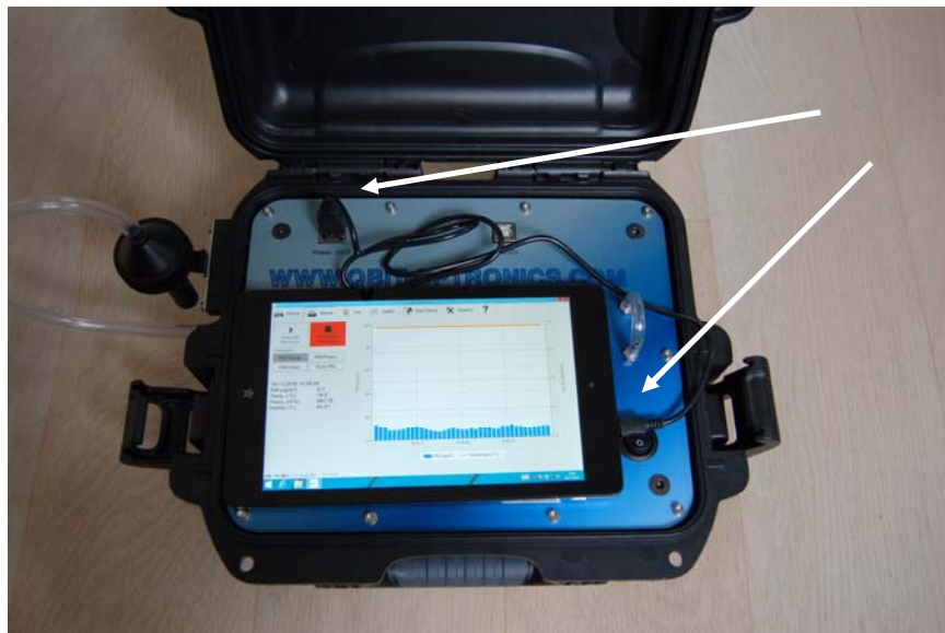
Figura III.3 Esempio di collegamento di Tablet alla presa USB-A. In questo modo il tablet risulta in carica attraverso l'alimentazione principale dello strumento (batteria, rete o pannello) e rimarrà acceso quanto lo strumento o più (grazie alla sua batteria interna).
