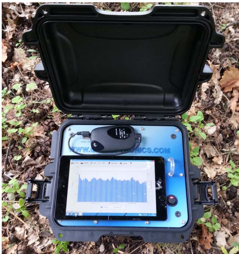
Figura III.8. Router wireless per collegamento rete cellulare (per tablet senza opzione 3G).
