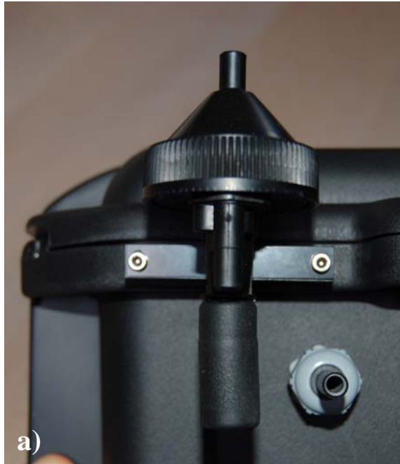
Figura III.5. Selettori di particolato.a) Ciclone per PM2.5 b) Filtro poroso per PM10.
