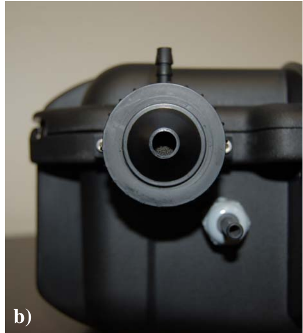
Figura III.5. Selettori di particolato.a) Ciclone per PM2.5 b) Filtro poroso per PM10.
